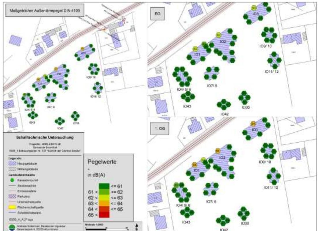
Abbildung 5: Maßgeblicher Außenlärmpegel, Quelle: Schalltechnische Untersuchung des Ingenieurbüros Kottermair GmbH, Altomünster vom 10.09.2019 - 6089.5 / 2019 – JB, Anlage 3.5
