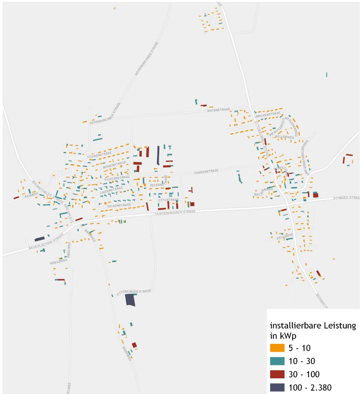
Abbildung 43: Süden - Installierbare PV-Leistung auf Dächern (eigene Darstellung INEV)
